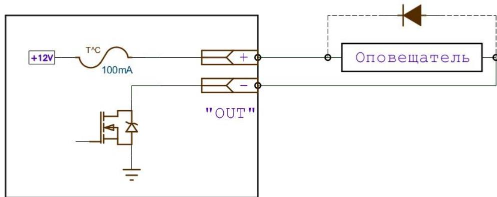
7.3. Каждый выход «Out1» или «Out2» настраивается независимо. Выбор номера выхода производится в утилите программирования нажатием на кнопку с соответствующим номером под надписью «Выходы УОО».
